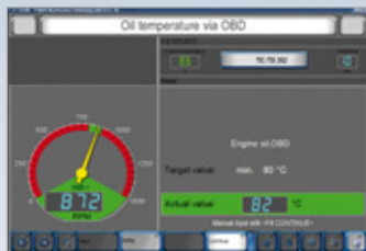
Revoluciones, temperatura del motor mediante OBD
